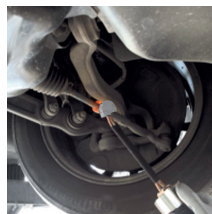
Déblocage des biellettes de direction
