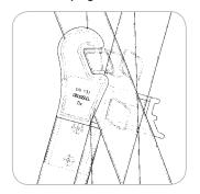
Les articulations en fonte d'aluminium s'accrochent à chaque échelon pour obtenir la position rattrapage de niveau, en cas de besoin La barre stabilisatrice télescopique « V inversé », permet le rattrapage de niveau latéral
