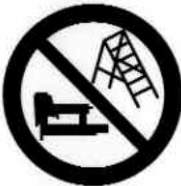
Unter der am 01.01.2001 in Kraft tretenden europäischen Norm EN 792-13 müssen Eintreibgeräte mit Kontaktauslösung mit dem Symbol "Nicht von Gerüsten oder Leitern benutzen" gekennzeichnet sein und dürfen nicht für bestimmte Anwendungen benutzt werden zum Beispiel :
