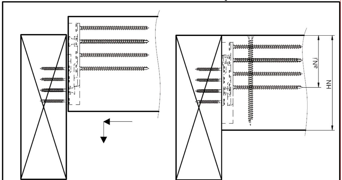
Distance du bord  $t_1$  en relation avec la hauteur de la poutre secondaire  $H_N$  et de la taille de RICON® S
