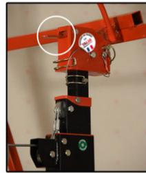
Verrouillage automatique de l'antenne en position horizontale.
