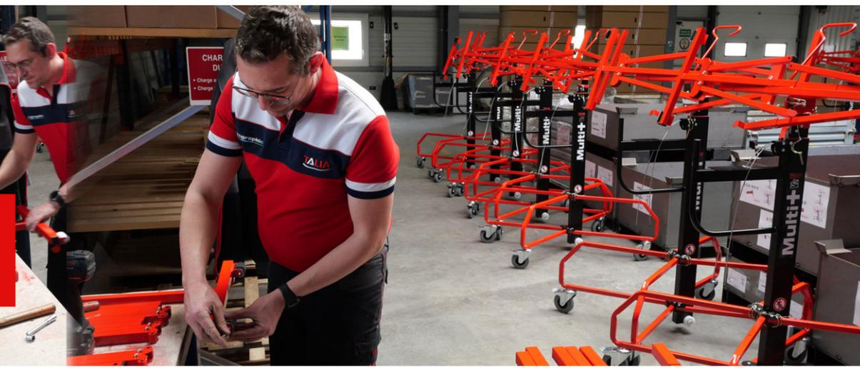
**Caractéristiques :** En acier finition peinture Epoxy - Format de plaque (maxi) : 3,6 x 1,2 m - Charge maximum : 70 kg.
