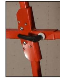
Poignées de serrage des 2 rallonges latérales de l'antenne, débrayables rapidement pour s'adapter à tous les formats de plaque.
