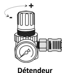
**NB :** Vérifier que la pression de réglage du détenteur soit toujours inférieure à la pression de redémarrage du contacteur manométrique. Sinon, vous n'aurez pas la pression désirée.
