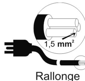
Si l'utilisation d'une rallonge électrique (longueur inférieure à 20 m) est nécessaire, n'utiliser que des câbles électriques normalisés et d'une section au moins égale à 1,5 mm<sup>2</sup> pour éviter tout échauffement ou perte de tension dans la rallonge. Pour choisir correctement la section de câble, veuillez vous référer au tableau ci-contre.
