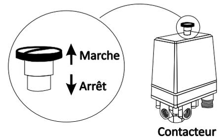
Toute intervention sur le compresseur suppose le débranchement du cordon d'alimentation (ou l'ouverture du sectionneur). Mettre le contacteur sur position arrêt et débrancher le cordon d'alimentation :
