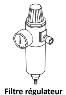
**NB :** Vérifier que la pression de réglage du filtre régulateur soit toujours inférieure à la pression de redémarrage du contacteur manométrique. Sinon, vous n'aurez pas la pression désirée.
