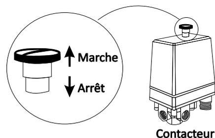
Toute intervention sur le compresseur suppose le débranchement du cordon d'alimentation (ou l'ouverture du sectionneur). Mettre le contacteur sur position arrêt et débrancher le cordon d'alimentation :
