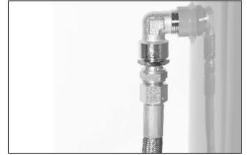
*Le flexible de liaison entre la cuve et la platine doit être Haute Température et tressé INOX pour résister à la température élevée de l'air en sortie de platine.*
