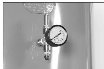
Sur la sortie basse de la croix mettre la réduction + le raccord instantané avec bague noire (étancher la liaison avec du ruban téflon fourni).
