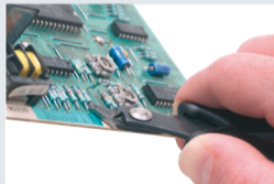
Pince coupe à ras tête fine. Diagonal cutting pliers - flush cut.
