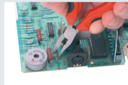
Manche bien calé dans la paume. Good position of the handle in the hand.
