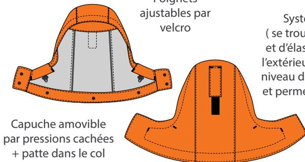
Système de patte avec pression (se trouvant sur l'intérieur de la parka) et d'élastiques cachés (se trouvant sur l'extérieur des softshells) positionnés au niveau de l'encolure dos et des poignets et permettant de les fixer l'une à l'autre.
