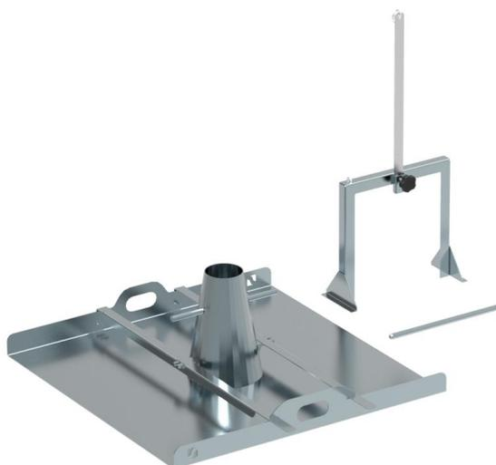
**Utilisation :** Mesure de l'étalement d'un béton.
