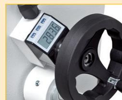
Butée équipée de 4 doigts repositionnables sur la longueur, réglage de la butée par compteur digital à cadran large. Commande latérale de déplacement de la butée par volant. Course de 5 à 750 mm - Réf. PVXBC2040 et PVXBC3080
