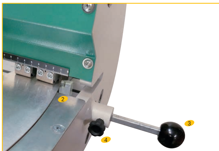
Butées latérales réglables de chaque côté de la machine (2), pour le poinçonnage des poissons, avec levier de basculement (3) et molette de verrouillage (4)
