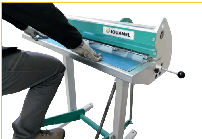
Poinçonnage de 6 trous Ø 3,2 mm en ligne en un seul mouvement
