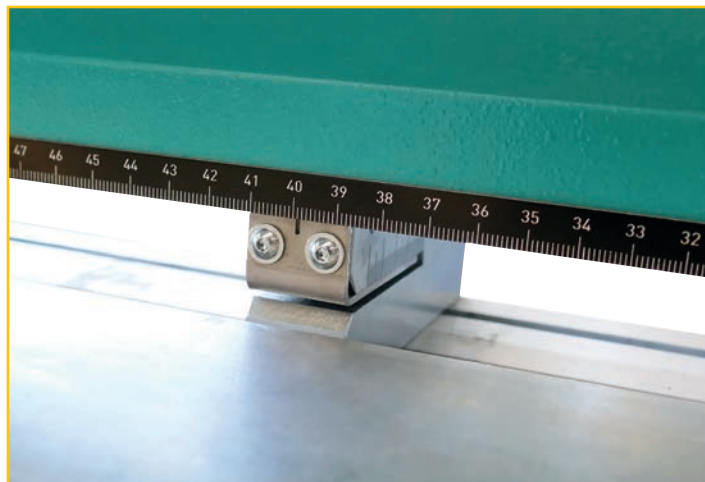
Positionnement des poinçons sur règle graduée
