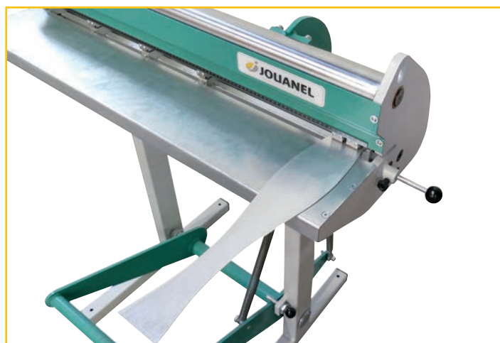
Poinçonnage de 6 trous Ø 3,2 mm en ligne en un seul mouvement
