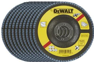
Grain d'oxyde de zirconium résistant et durable, Modèle de type 27 pour le meulage d'angles de 0 à 15 degrés, Conception de type 29 pour des angles de meulage de 15 à 25 degrés
