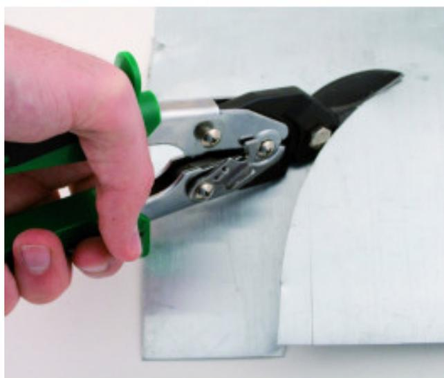
Cisaille à tôle articulée chantourneuse.
