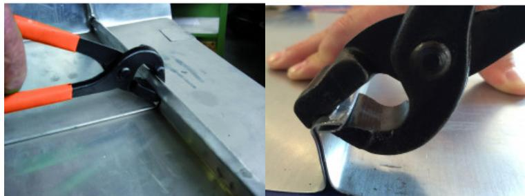
Permet de déplier les joints debouts et les gouttières.
