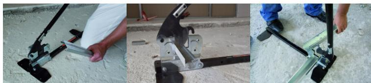
Pour couper rapidement et sans bavure les rails et montants de 48 mm, cornières d'angles, suspentes en T et montants F530 avec l'accessoire de coupe.
