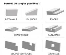
Coupe nette des isolants tels que les panneaux de laine de roche, laine minérale, laine de verre, polyuréthane, polystyrène expansé et extrudé (P.S.E. et X.P.S.), mousse résolique, mousses de verre, de caoutchouc. Sur batterie pour une plus grande liberté de travail.
