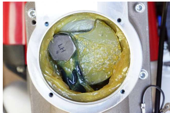
Figure 2 Zone du vilebrequin avec suffisamment de graisse. La graisse est jaune avant que l'appareil soit utilisé et devient marron au fil du temps et des utilisations
