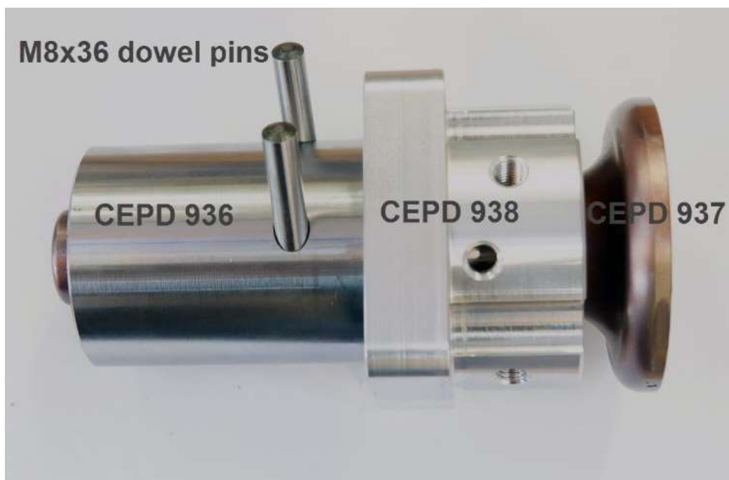
Figure 3 Partie du marteau CHPD Easy
