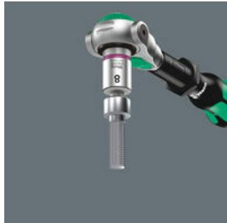
Le serrage de la vis à six pans creux sur la douille-embout est assuré par une bille élastique en contact avec l'embout. Particulièrement utile dans les espaces de travail d'accès difficile, où l'on ne peut pas se servir de l'autre main pour maintenir la vis.
