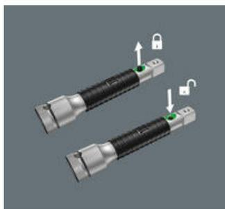
Les rallonges des séries haut de gamme sont par ailleurs équipées du système "flexible-lock". Son activation permet de fixer aussi longtemps que nécessaire les douilles sur la rallonge. L'outil ne peut plus être égaré ou tomber. Lorsque le système est désactivé, les douilles peuvent être emboîtées et échangées très rapidement.
