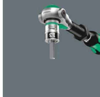
Le maintien de la vis hexagonale dans la douille à carré est assuré par deux billes élastiques et une gaine thermorétractable haute résistance à élasticité permanente. Celle-ci est protégée contre les endommagements mécaniques par une collelette d'acier située à l'avant. Particulièrement utile dans les espaces de travail d'accès difficile, où l'on ne peut pas se servir de l'autre main pour maintenir la vis.
