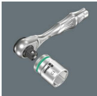
Le cliquet Zyklop Mini 3 est l'outil idéale pour visser lorsqu'il n'y a pas de place. La denture fine (60 dents) assure un angle de reprise de 6° seulement ; le moletage permet un vissage rapide particulièrement dans les espaces restreints.
