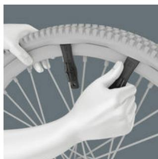
Les démonte-pneus en plastique renforcé de fibre de verre permettent de retirer les pneus de la jante, sans endommager la jante. Avec un des démonte-pneus, faire levier avec la jante et l'accrocher dans un rayon et détacher le pneu avec le deuxième démonte-pneu. Pour éviter qu'ils ne se perdent, les deux démonte-pneus se fixent l'un dans l'autre.
