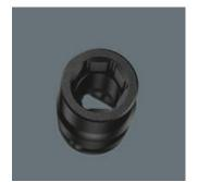
Le profil à six pans permet la transmission de forces élevées et sollicite moins les pans de l'écrou ou de la tête de vis qu''un profil à douze pans. Grâce à leur angle de reprise limité, les cliquets à denture fine rendent l'utilisation d''un profil à douze pans superflue, même dans les espaces restreints.
