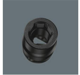
Le profil à six pans permet la transmission de forces élevées et sollicite moins les pans de l'écrou ou de la tête de vis qu'un profil à douze pans. Grâce à leur angle de reprise limité, les cliquets à denture fine rendent l'utilisation d'un profil à douze pans superflue, même dans les espaces restreints.
