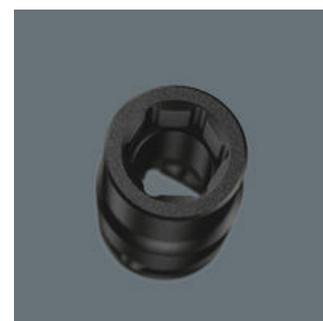
Le profil à six pans permet la transmission de forces élevées et sollicite moins les pans de l'écrou ou de la tête de vis qu'un profil à douze pans. Grâce à leur angle de reprise limité, les cliquets à denture fine rendent l'utilisation d'un profil à douze pans superflue, même dans les espaces restreints.
