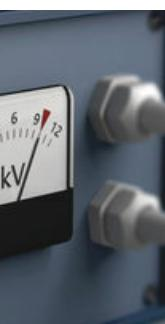
Le contrôle unitaire sous 10 000 volts conformément à la norme IEC 60900 garantit un travail en toute sécurité jusqu"à 1 000 volts.
