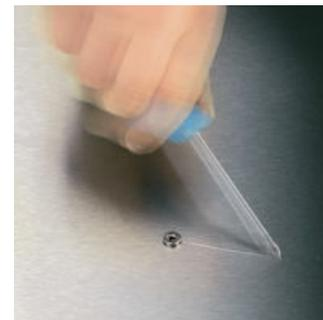
Riper hors de la vis est chose courante lors du vissage. Il arrive même que l'on s'endommage au passage des surfaces coûteuses, voire que l'on se blesse. La pointe des tournevis Wera Lasertip fait l'objet d'une découpe striée microscopique par rayon laser. Cette surface rugueuse vient littéralement "mordre" dans la tête de vis. Fini les dérapages intempestifs !
