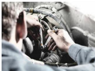
La denture exceptionnellement fine (80 dents) du mécanisme à cliquet côté œillet offre une souplesse maximale, même aux endroits exigus.
