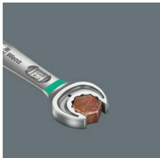
La géométrie 12 pans de Joker assure une liaison précise avec la vis ou l'écrou - une liaison qui tient ! Et la plaque interchangeable en métal trempé située dans la fourche de Joker "enserme" littéralement la vis de ses pointes extrêmement dures. Deux atouts permettant d'éviter tout dérapage malencontreux, même lors de serrages avec couples élevés.
