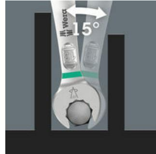
La clé mixte Joker 6003 avec sa fourche 12 pans et coudée à 7,5° double les possibilités d'ancrage lors de la rotation à 180° de la clé . Les écrous ou têtes de vis peuvent être "agrippés" tous les 15°. La Joker 6003 trouve pour ainsi dire d'elle-même le point d'ancrage suivant à chaque rotation.
