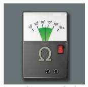
La résistance électrique superficielle du matériau Wera ESD est ≤ 10^9 ohms. Les composants sont ainsi protégés à coup sûr contre l'électricité statique et les dommages corollaires.
