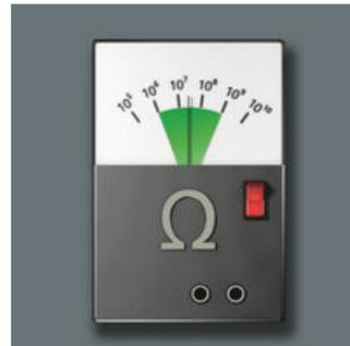
La résistance électrique superficielle du matériau Wera ESD est  $\leq 10^9$  ohms. Les composants sont ainsi protégés à coup sûr contre l'électricité statique et les dommages corollaires.
