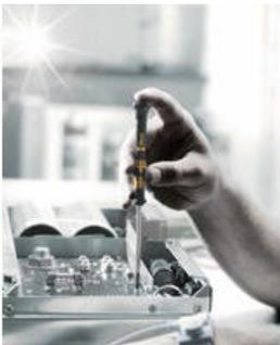
Aucune décharge électrostatique ne doit se produire lors du vissage de composants électroniques (comme dans les smartphones ou les tablettes), puisqu'il risque de s'ensuire des dysfonctionnements, voir des pannes. Des outils de vissage antistatiques s'avèrent donc indispensables.
