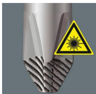
À l'aide d'un laser extrêmement concentré, on génère une structure superficielle acérée. La dureté des stries réalisées par ce procédé atteint jusqu'à 1000 HV 0,3. Wera Lasertip s'agrippe dans la tête de vis et empêche le dérapage hors de celle-ci. Pour vis à fente, Phillips et Pozidriv.
