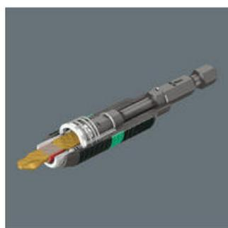
Le fonctionnement du système BiTorsion est basé sur la combinaison de deux éléments amortissants qui absorbent les chocs. Les embouts, tout comme les porte-embouts, présentent une zone de torsion jouant le rôle d'amortisseur qui évacue hors de la pointe d'attaque l'énergie cinétique survenant lors des pics de contrainte.
