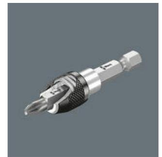
Pour une jonction ferme, non vacillante entre le support et l'embout. Découplage très rapide : il suffit de faire coulisser la douille vers l'avant et de changer l'embout. En version non-magnétique pour éviter l'aimantation de limaille.
