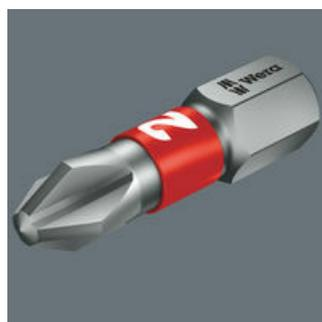
Les embouts BiTorsion constituent le très haut de gamme. Ils sont dotés d'une zone BiTorsion plus tendre, le corps de l'embout présentant une dureté environ 20 % inférieure à celle de la pointe d'attaque. Le gauchissement de la pointe de l'embout lors des pics de contrainte est pour une large part évité, ce qui accroît davantage encore la durée de vie des embouts.
