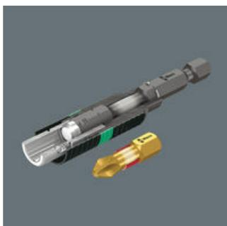
Ajustées de manière optimale, les courbes caractéristiques des zones de torsion de l'embout et du porte-embouts permettent un relâchement graduel en cas de contrainte. Le système en deux phases empêche l'usure précoce. La haute longévité de l'outil est par ailleurs garantie par la dureté des embouts, calibrée en fonction de l'application respective.
