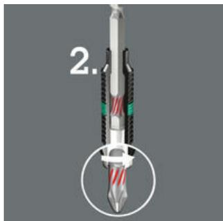
Les pics de contrainte majeurs sont minimisés par l'effet de torsion du corps de l'embout (phase 2). Cet effet est obtenu grâce à un traitement thermique ciblé à l'issue de la trempe de l'embout. Il permet de réduire la dureté du corps par rapport à celle de la pointe d'attaque.
