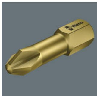
Les embouts TH sont des embouts extra-durs avec en plus une zone de torsion. Ces embouts permettent d'amortir les pics de couple dans cette zone évitant ainsi l'usure précoce ; les embouts gagnent en longévité.
