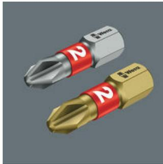
Les embouts BTH (extra-dure) et BTZ (extra-rigide) sont dotés d'une zone BiTorsion obtenue par trempe du corps pour obtenir une dureté env. 20 % inférieure à celle de la pointe d'attaque. La gauchissement de la pointe de l'embout lors de la survenue des pics de contrainte est en grande partie évitée, ce qui accroît davantage encore la durée de vie des embouts.
