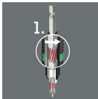
Le ressort de torsion intégré dans le porte-embouts BiTorsion permet d'amortir les pics de contrainte mineurs (phase 1). Un mécanisme d'appoint permet d'éviter efficacement toute surcharge de ce ressort.
