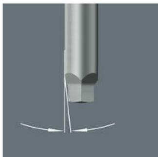
Les embouts V se distinguent par une pointe conique. La force de serrage ainsi générée maintient en toute sûreté les vis carrées sur la pointe de l'outil. L'idéal pour le vissage en des endroits d'accès difficile.
