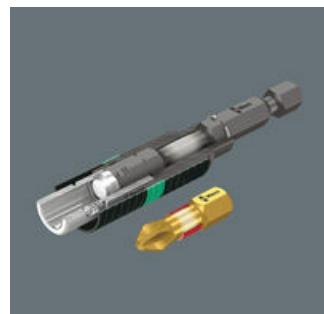
Ajustées de manière optimale, les courbes caractéristiques des zones de torsion de l'embout et du porte-embouts permettent un relâchement graduel en cas de contrainte. Le système en deux phases empêche l'usure précoce. La haute longévité de l'outil est par ailleurs garantie par la dureté des embouts, calibrée en fonction de l'application respective.
