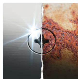
L'emploi d'embouts en acier inoxydable permet de prévenir l'apparition de rouille erratique sur les vis ou les surfaces inox. Un phénomène dû avant tout à la limaille produite lors du vissage avec des outils en acier ordinaire. Ces particules de limaille d'acier, sous l'action de l'oxygène, entraînent la rouille.
