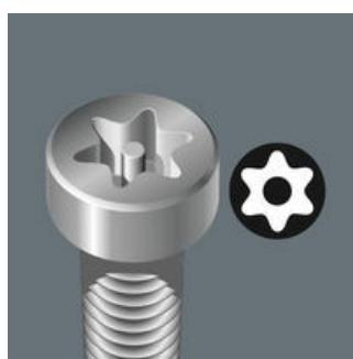
Conçu pour empêcher le dévissage non autorisé de vis dites "de sécurité". Afin de proscrire l'emploi d'outils TORX® "normaux", ces vis sont munies dans leur profil d'entraînement d'une goupille faisant saillie. Celle-ci pénètre dans l'alésage des outils TORX® BO, permettant le desserrage des vis. Ce type de vis de sécurité se retrouve notamment sur de nombreux appareils électriques dont le démontage ou l'entretien doivent être réservés à des techniciens dûment formés.
