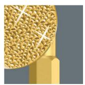
minuscules particules de diamant garnissant la pointe de l"outil viennent littéralement "mordre" dans la vis et offrent un parfaitement positionnement ajusté et antidérapant dans la tête de cette dernière. Се positionnement sûr ménage la vis. Les forces de rejet ("cam-out") qui obligent l'utilisateur à exercer une pression élevée sur la vis sont considérablement réduites.
