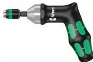
Ces outils sont idéaux pour toutes les applications où l'on a constamment besoin du même couple et d'une précision à la fois élevée et répétitive. La valeur du couple peut être modifiée à l'intérieur de la plage de mesure. Retirer pour ce faire le capuchon situé en haut du manche et actionner l'écrou de réglage au moyen d'une clé à douille.
