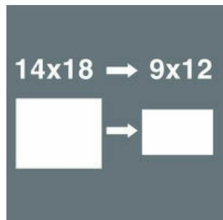
Pour adapter les outils à attachement 9x12 mm sur une clé dynamométrique avec attachement 14x18 mm.
