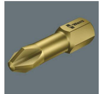
Les embouts TH sont des embouts extra-durs avec en plus une zone de torsion. Ces embouts permettent d'amortir les pics de couple dans cette zone évitant ainsi l'usure précoce ; les embouts gagnent en longévité.
